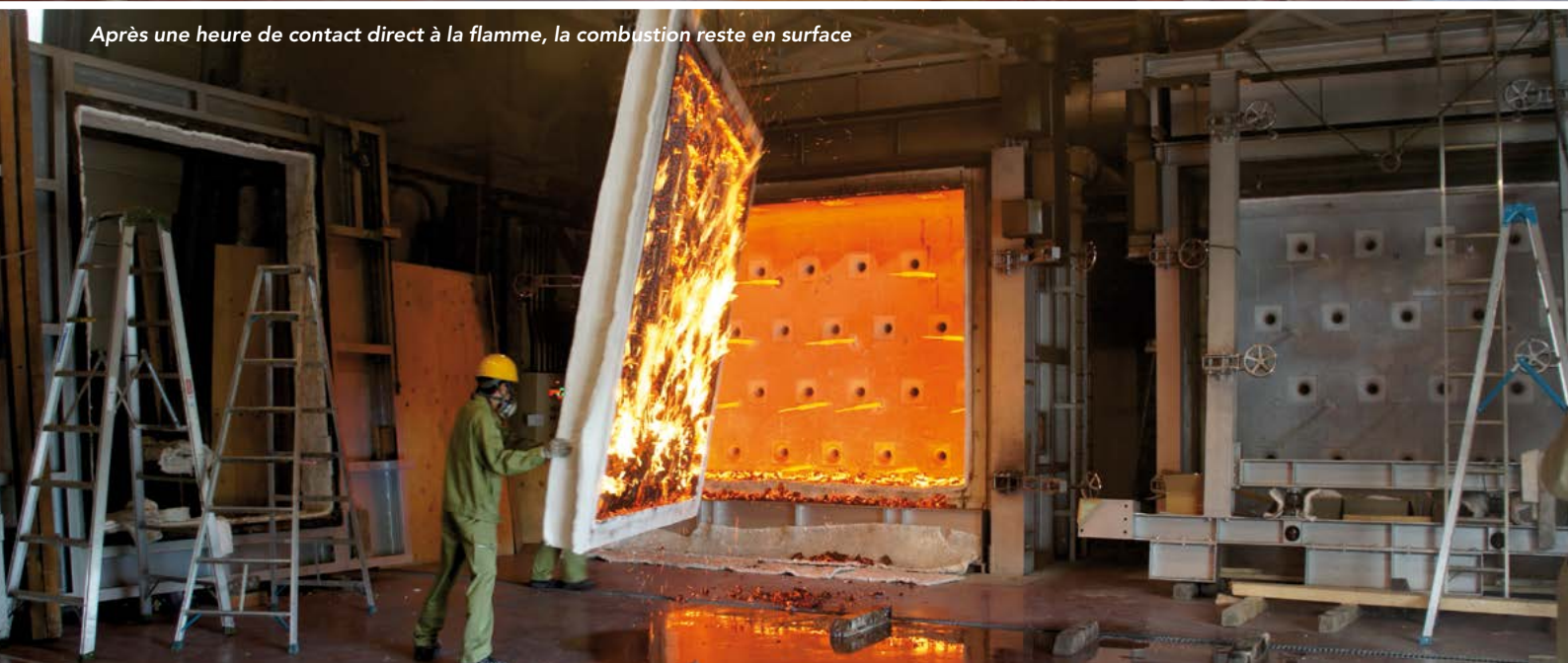
Après la combustion et avant l'extinction il ne résulte qu'une faible activité de feu
