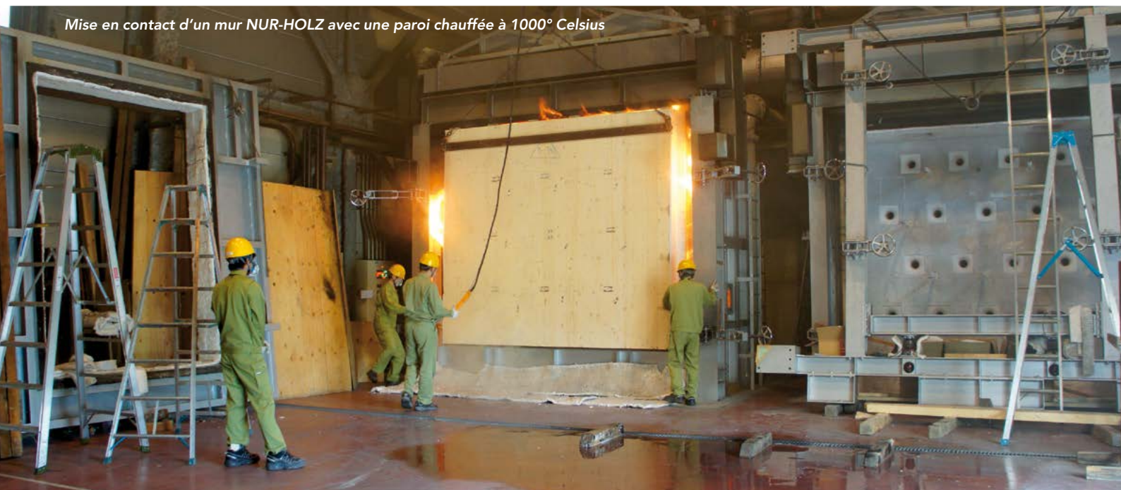
Après une heure de contact direct à la flamme, la combustion reste en surface
